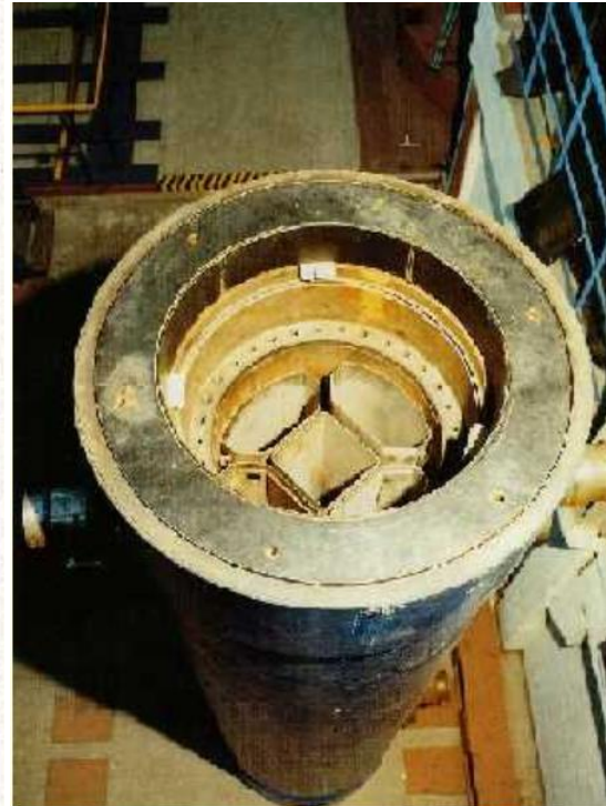
Pollux-Prototype-Container (Source: "Direkte Endlagerung", Kernforschungszentrum, Karlsruhe 1990)
